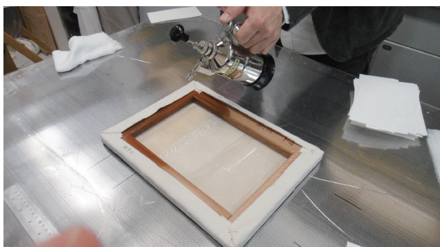
図8 サクションテーブルの上で、サンプルに霧吹きで水分を与えて脱塩を試みる Fig. 8 Attempting desalination by providing moisture with an atomizer to the sample on top of the suction table.
